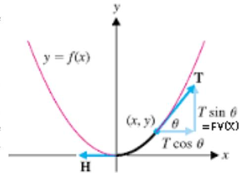
Bei genauerer Betrachtung stellt man fest, dass sich  $F_V(x)$  sich als Produkt der Länge des Seilstücks  $L$  vom Scheitel bis zum betrachteten Punkt  $(x|y)$  ( $L =: s(x)$ ), multipliziert mit der Masse je Meter Seil  $\mu$  und dem (Erd-)Beschleunigungsfaktor  $g$  dargestellt werden kann. Es gilt also:
